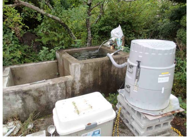
○自動採水装置の設置例(浪江町)
