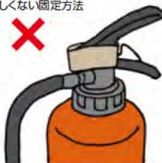
ストッパーが固定されていない
