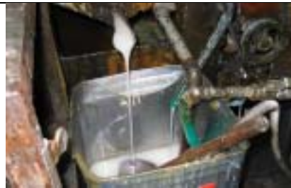
写真1 接着剤塗布部からの余剰接着剤の循環タンク
