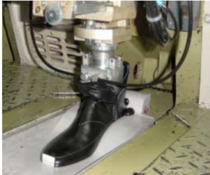
写真1 射出成型の様子
