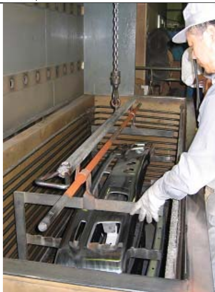
写真3 冷却ゾーンにおける液切りの様子
