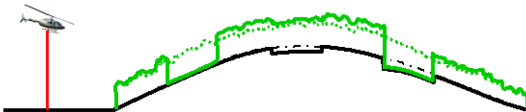
B. 期末の森林の状態(上)とその航空レーザー測定による樹冠面と地形面(下)
