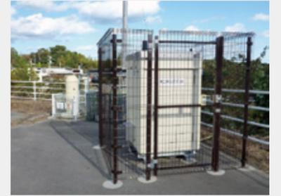
福島の現地の様子。一番上は仮置場へと搬入されてきた除去土壌入りフレコンバッグを荷台から下ろす様子。中央は中間貯蔵施設の内部で、搬入された土壌の汚染濃度を計測し分別する作業。下は中間貯蔵施設の区域境界に設置されたモニタリングポスト。大気中の放射線量等を継続的に測定、監視している。
