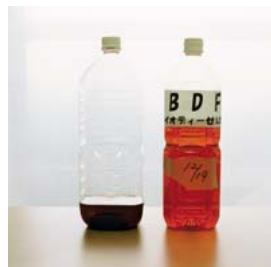
精製前の廃油(左)と、精製後のBDF(右)。
