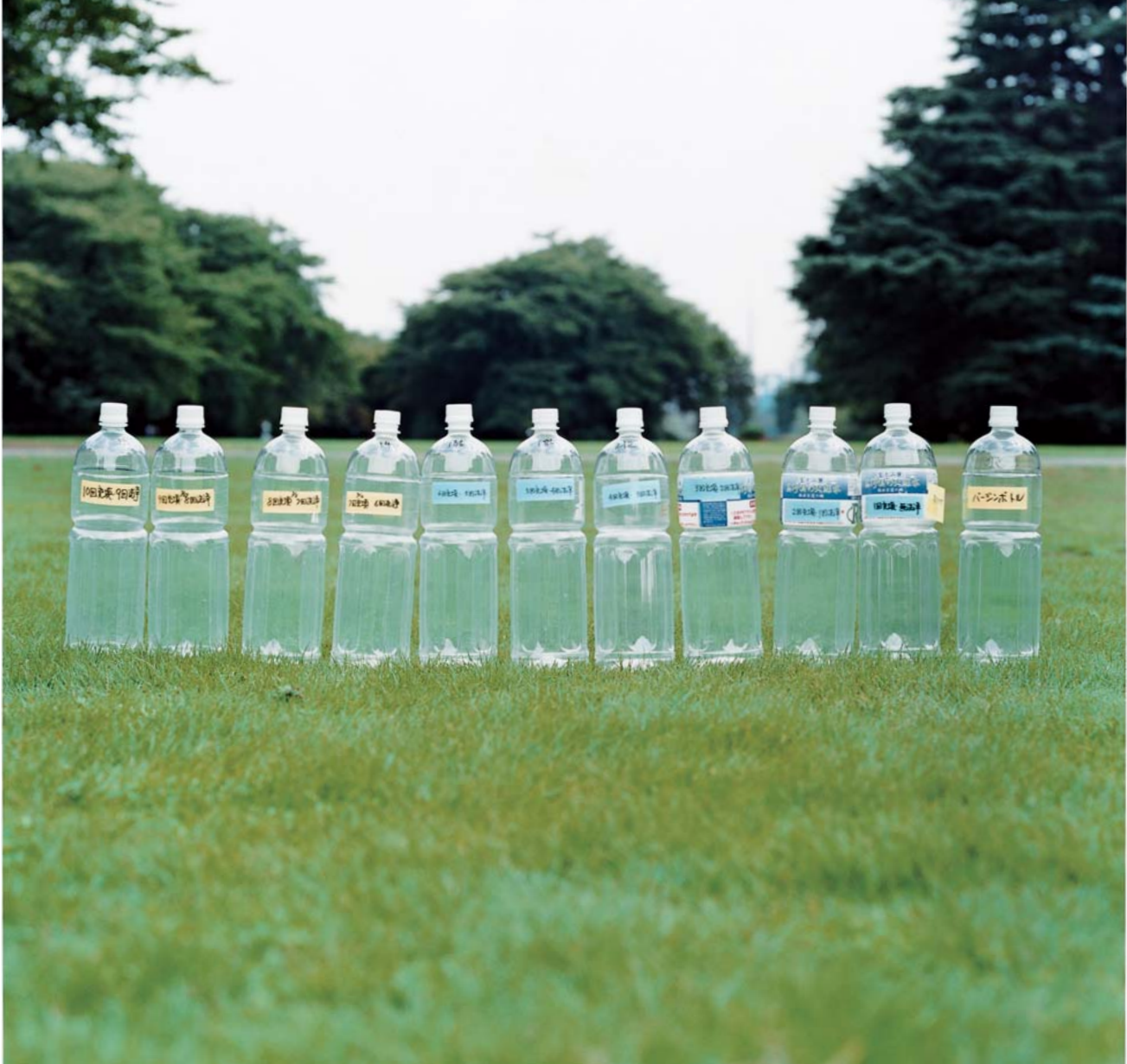
パルシステムでは、リユース用のペットボトルを10回リユースする実験を行った。右が一度も使っていないパーソンのボトルで、左端が10回使用のもの。多少ボトルに細かい傷がつくが、充分使用に耐えることが証明された。
