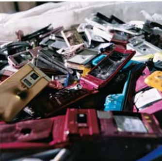
買い替えなどで持ち込まれた携帯電話には、個人情報保護のためショップで破碎された上で持ち込まれる。
