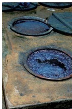
岡山の高城染工にある藍ガメ。温度管理のため地中に埋められているので、染めの仕事はとても手間のかかる重労働だ。
