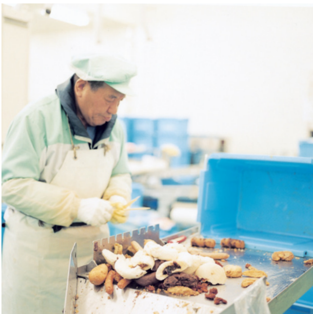
②分別-2 串にささったフランクフルトや団子などは、人が見つけて1本ずつ手ではずします。そのほか紙のカップを除いたり、紙をはがすのも人の手でしかできない作業。
