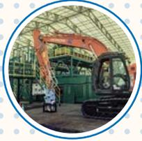
施設内の荷おろし設備において、県内の仮置場などから輸送された除染土壌などを破袋機にかける
