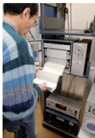
国立環境研究所に設置されたオゾン濃度の測定装置
