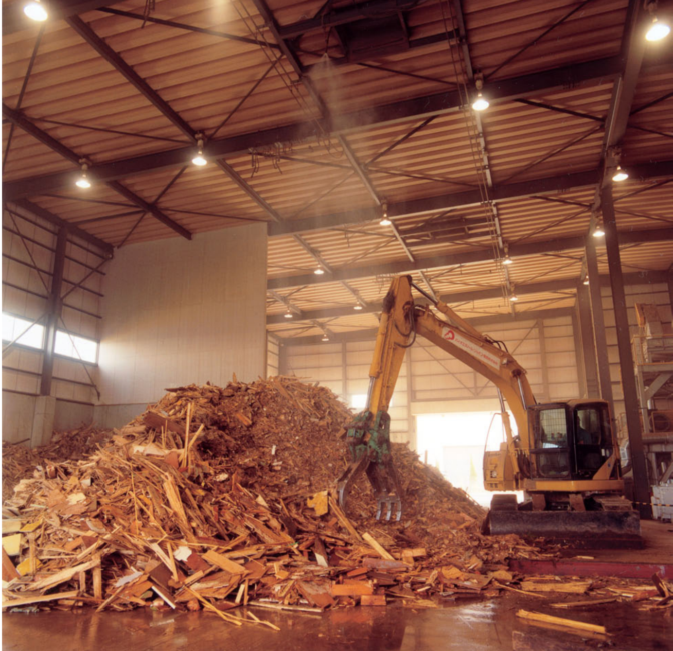
集められた建設廃木材や剪定枝などの山。エタノールの原料となるのは、ビュアな木材のみ。接着剤や防腐剤を含む建材は、ボイラーの燃料として使われる。
