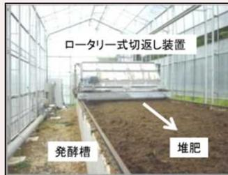
浅型ロータリー方式堆肥化施設(固形物処理)
