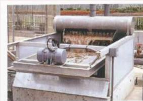
固形物を除去する振動篩(汚水処理)
