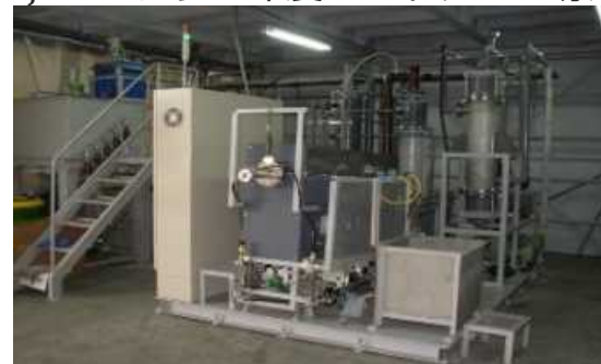
専焼型破壊設備の例 (フロンJCMによりR2年度にベトナムに導入済)
