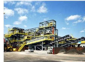
土壌分級プラントの例 (※)分級とは、セシウムが細粒分に付着しやすい特性を踏まえ、除去土壌をふるい等につけ、粒度別(シルト、年度、砂、レキ)に分離する技術
