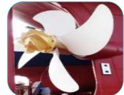
CFRPプロペラ
