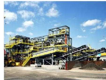
土壌分級プラントの例 (※)分級とは、セシウムが細粒分に付着しやすい特性を踏まえ、除去土壌をふるい等に加え、粒度別(シルト、粘土、砂、レキ)に分離する技術
