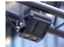
警察が整備を進める情報通信装置。赤外線により信号情報を始めとする各種の情報を車両に提供する。車載装置と双方向通信が可能。
