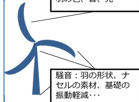
騒音：羽の形状、ナセルの素材、基礎の振動軽減・・・
