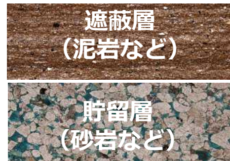
二酸化炭素の貯留に適した地層の調査
