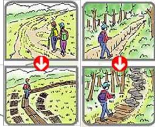
木道整備や植生復元 洗掘箇所の復元
