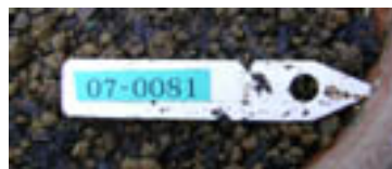
写真 4-2. 拡大 ラベル---プラスチック製、刻印---ラ ベルライターで印字したシール。 耐久性は劣るため、毎年交換する。
