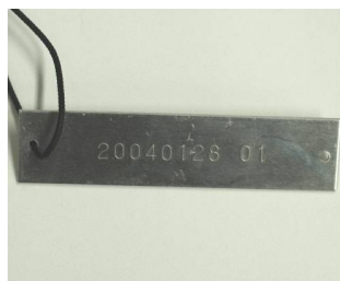
写真 2-2. 拡大 刻印---専用の道具で刻印し、 容易に消えない。
