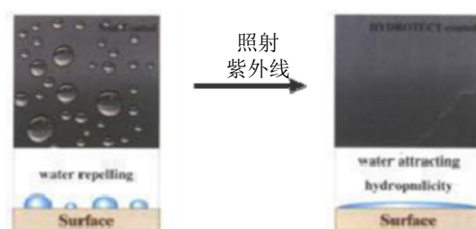
图 8 HYDROTECT 的亲水作用
