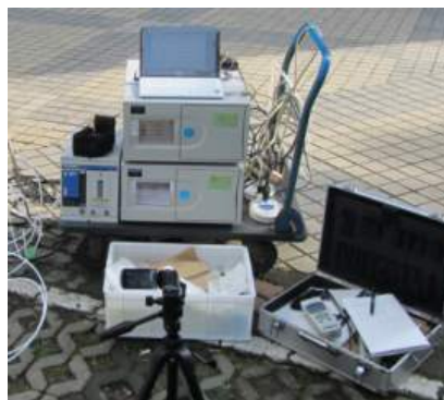
图 3. 氮氧化物浓度监测仪 APNA-370 (堀场制作所)
