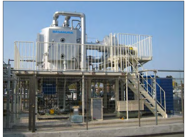
大容量の濃縮処理に適した、ヒートポンプ利用の 高効率型 VVCC 濃縮装置
