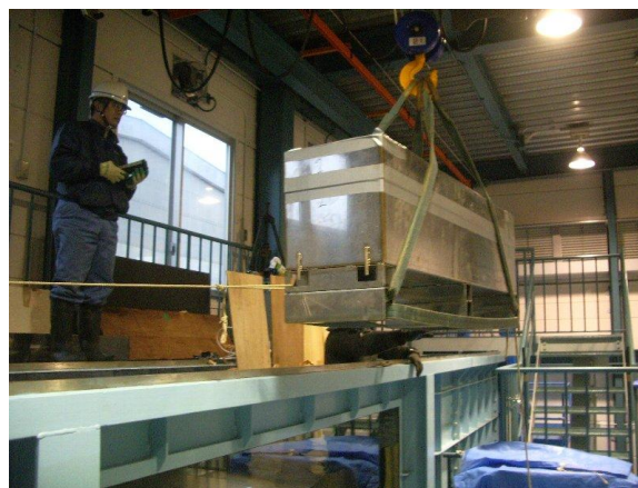
図 1 - 7 実験水槽への現地泥敷設状況
