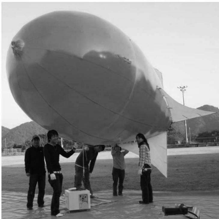
図 1 - 8 サンプラーを 2 台搭載できる 18 m<sup>3</sup>の係留気球
