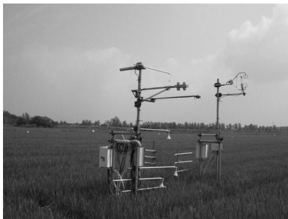
図1 中国江蘇省江都のオゾンフラックス観測点（JND観測点）の状況（2007年8月）
