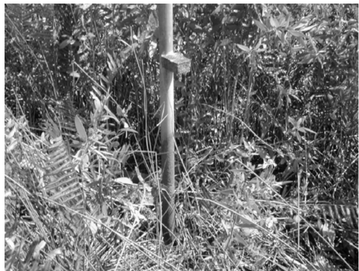
図 3. 泥炭消失量測定用杭
