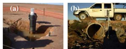
図4 塩湖に設置された水位計 (Bluewell, Lake View)と流量計(Ernie)の外観
