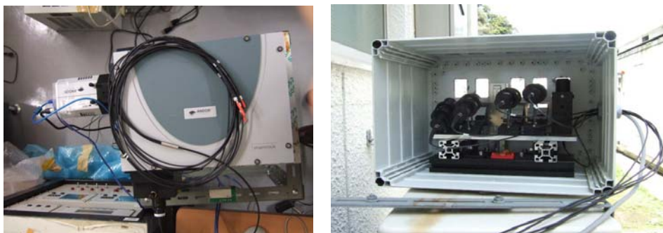
図2. 改良型MAX-DOAS装置の(左)紫外可視分光器と(右)受光部。
