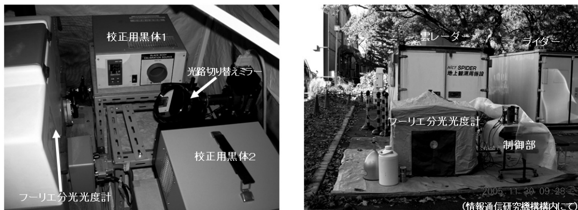
図8 フーリエ分光放射計システムの外観(左図)と、雲レーダー、および、ライダーとの同時観測の光景。
