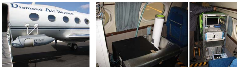
図8 ガルフストリームII型機のポッドに搭載された雲レーダ(写真左)とキャビン内のライダー装置(中央と右)。
