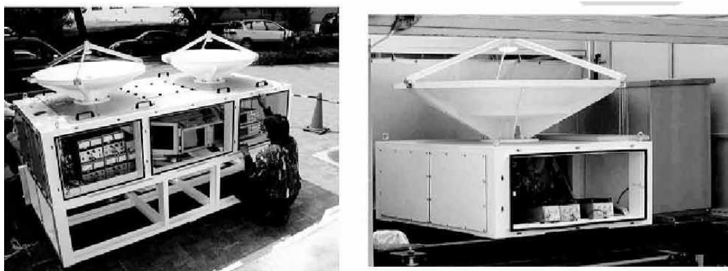
図5 開発されたミリ波FM-CW型雲レーダFALCON-I (左)およびFALCON-II (右)
