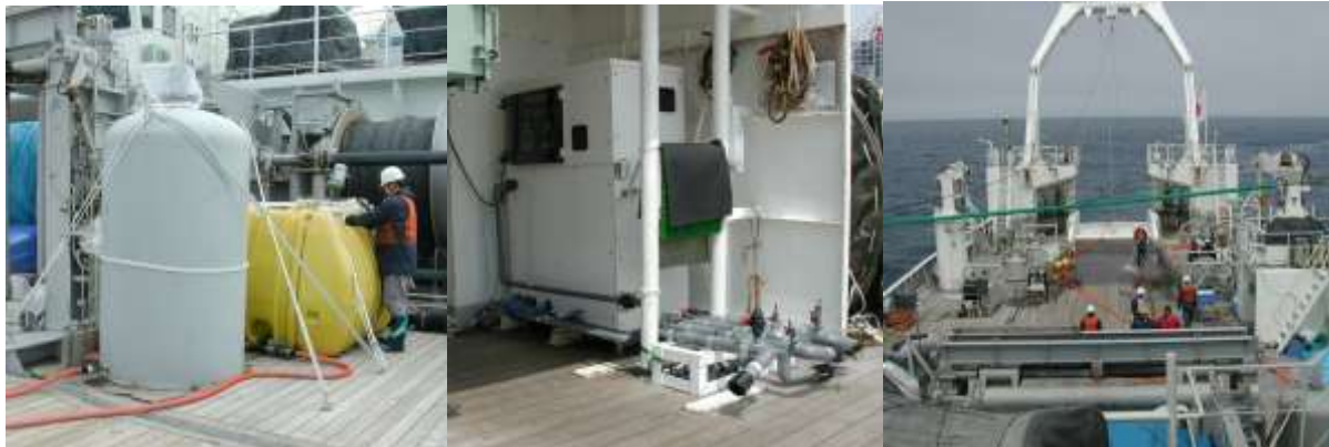
写真1 左：ねずみ色がSF 6 溶解タンク、黄色が鉄溶解タンク 中央：混合散布装置、定量ポンプにより二液を混合し放出する 右：散布風景、散布装置からホースが伸び船尾水深3 mより放出
