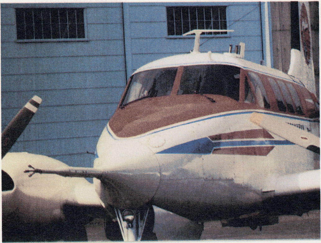
図3 航空機先端部に装着した超音波風速計
