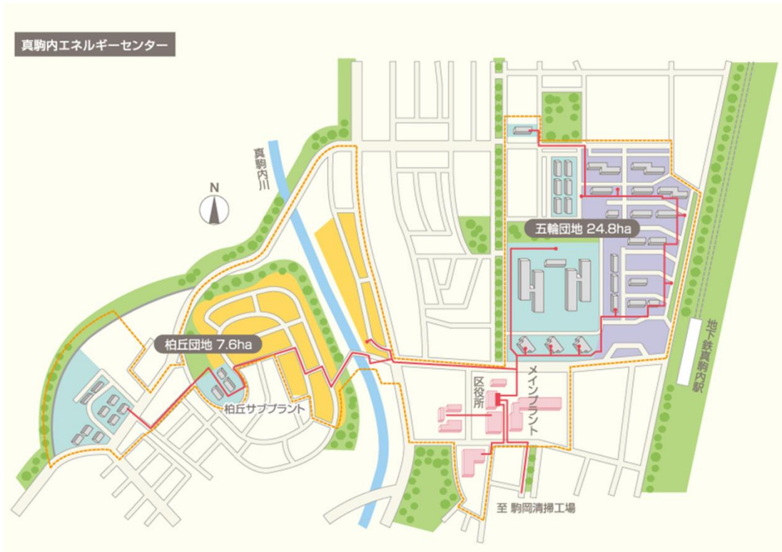
図 4-59 北海道地域暖房(株)真駒内エネルギーセンターの熱供給導管図 出所：北海道地域暖房（株）パンフレット
