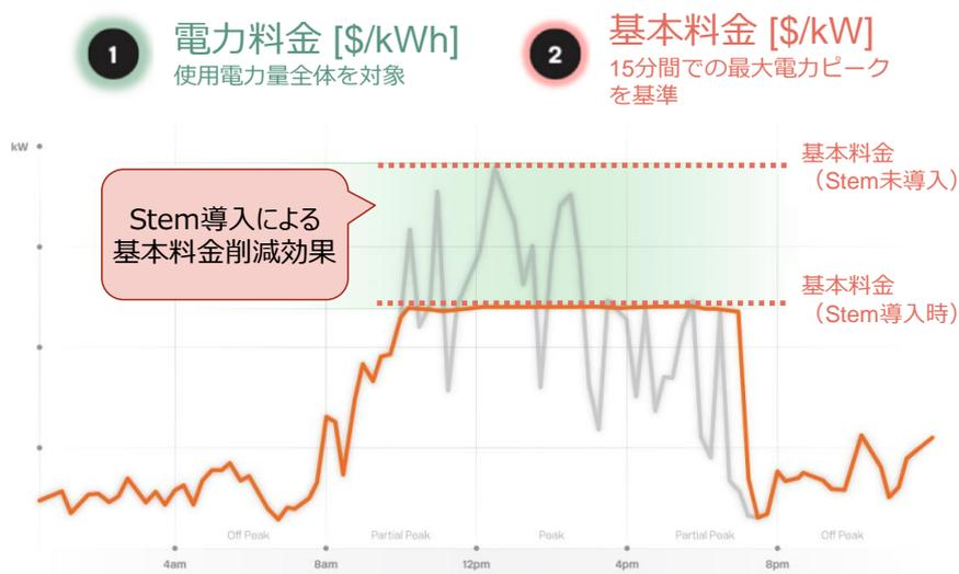
図 3-6 Stem 導入による基本料金削減
