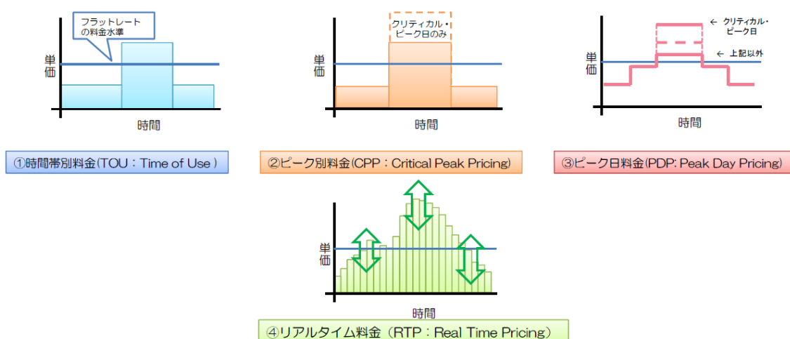
図 5-14 電気料金の設定によるデマンドレスポンスの例
