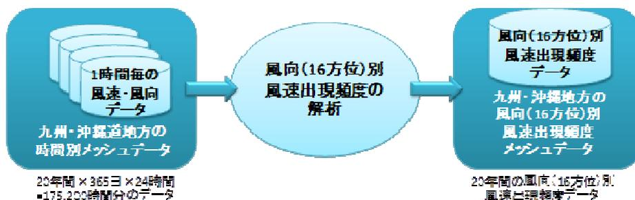
図 2-13 九州・沖縄地方における風向（16 方位）別の風速出現頻度データ作成フロー
