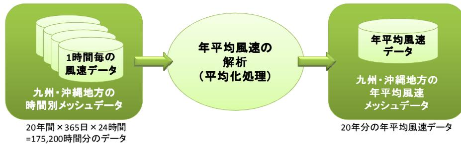
図 2-12 時間別風速データから年平均風速データに変換する処理の概念図
