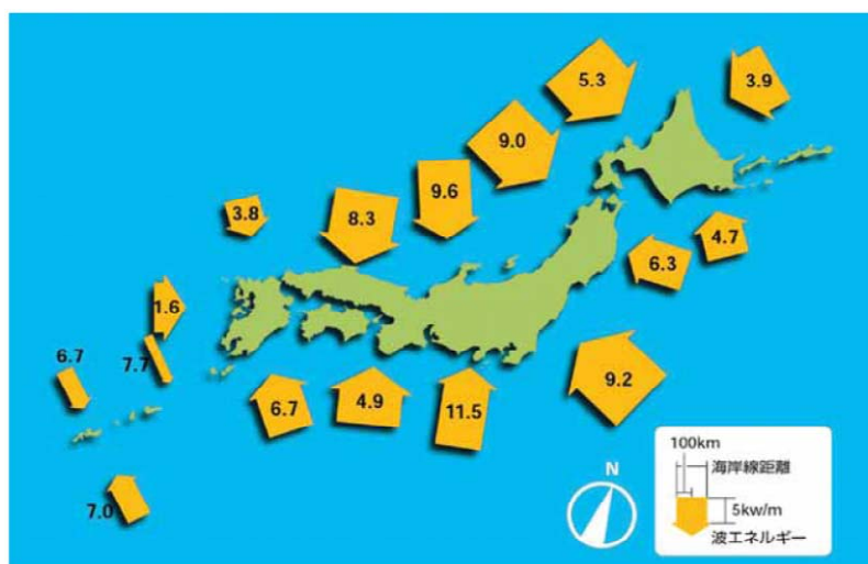
図 2.9-2 日本沿岸の波力エネルギー (kW/m)
