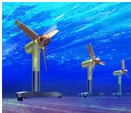
図 2.9-17 潮流発電システムイメージ
