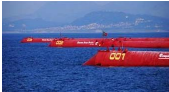
図 2.9-13 Pelamis 波力発電装置
