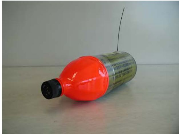
図 5.11-21 第1期モデル調査で使用した GPS アルゴス発信機付漂流ボトル
