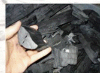
流木の有効利用 (左:木ブツ、右:窯にて炭化処理)
