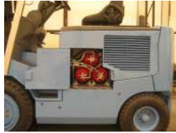
カセット式FCフォークリフト 容器交換口
