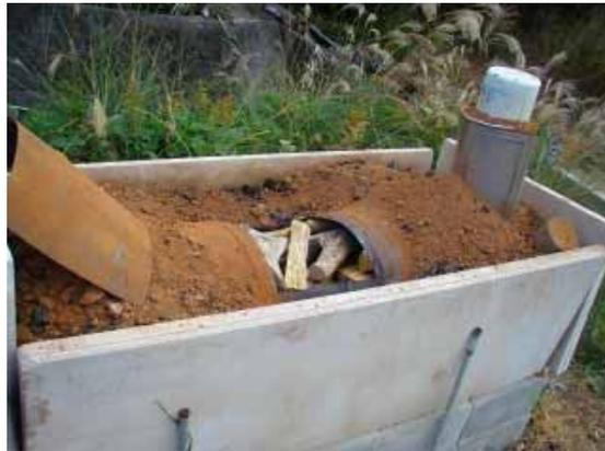
図5 炭材の窯への詰め込み
