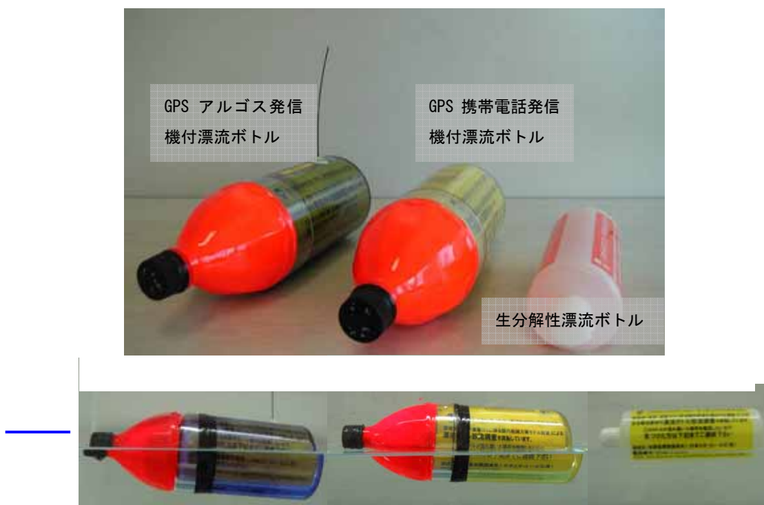
図 5.1-2 各漂流ボトルの外観と海水中での沈下状況（塩分濃度 32.5 の海水にて撮影）
