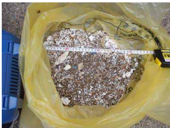
図 3.2-10 背負い式掃除機の吸引力の確認風景
