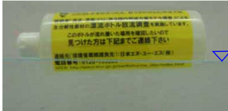
図 9.1-2 漂流ボトルの沈下状況（塩分濃度 32.5 の海水を使用）
