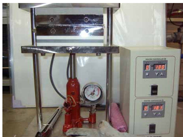
図 3.2-16 円盤状コースターを作成した熱プレス機
