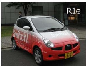
電気自動車用セルを搭載しフリート試験実施中の電気自動車
