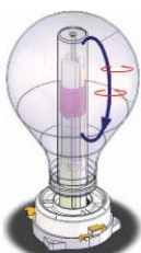
誘導電界により発光する 無電極ランプ技術
